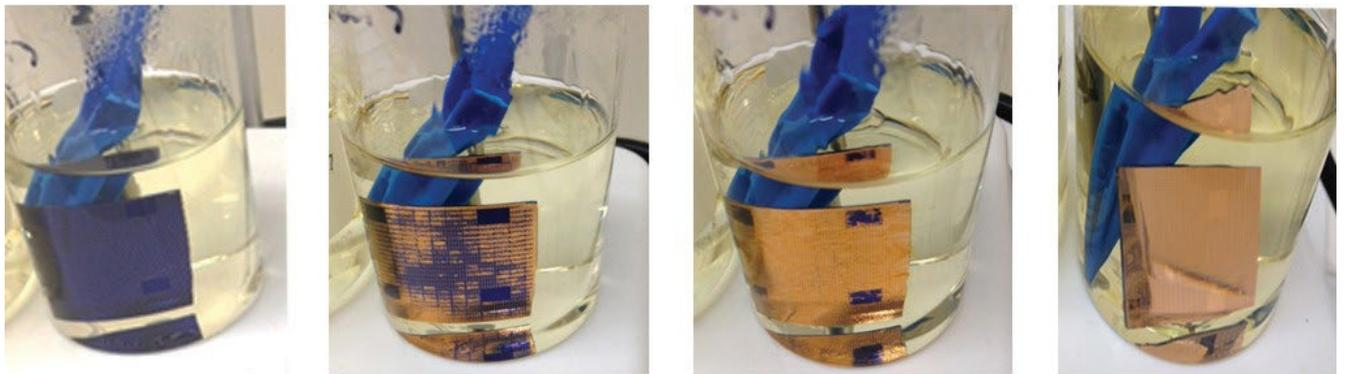
如图示, 为使用TechniStrip® NF52 从晶圆上剥离干膜光刻胶的过程, 该工艺完全溶解基板上的光刻胶, 不会在晶片中留下任何残留颗粒或悬浮在溶液中。
