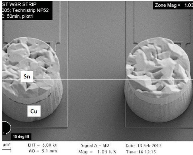
对 WBR 2100 光刻胶测试结果显示: TechniStrip® NF52 具有良好的剥离性, 而对基材无影响
